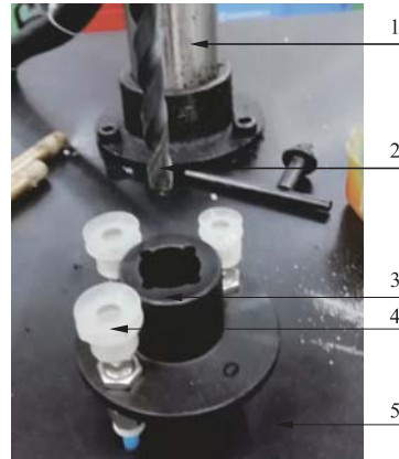
1. 钻床本体 2. 钻头 3. 夹具体 4. 真空吸盘 5. 底板
